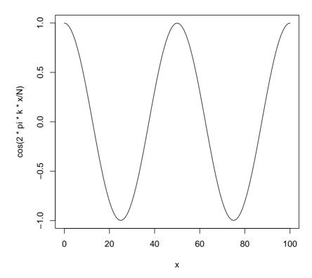
Figura 1: Segundo armónico de la función coseno
